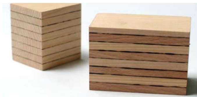
Cube composé de couches alternées de hêtre (foncée) et d'épicéa (claire) soudées par friction. La ligne noire entre les deux couches correspond à la zone de soudure.
